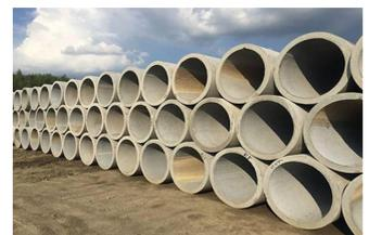
3.1.2 重力流雨、污水管最小管径不应小于400mm，管材直径大于600mm采用钢筋混凝土管，不得使用平接口排水管。在设计中道路雨水管材的选
