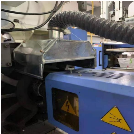
图 4-4 同类型项目注塑废气收集措施工程实例
