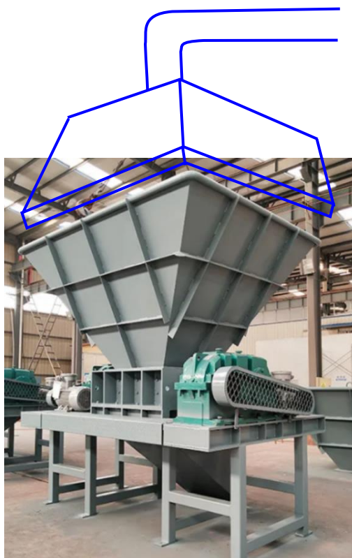
图 4-4 建筑垃圾破碎机拟建集气罩图片
