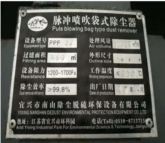
图 4-9 破碎、筛分、制砂、搅拌工序粉尘治理装置具体规格图片
