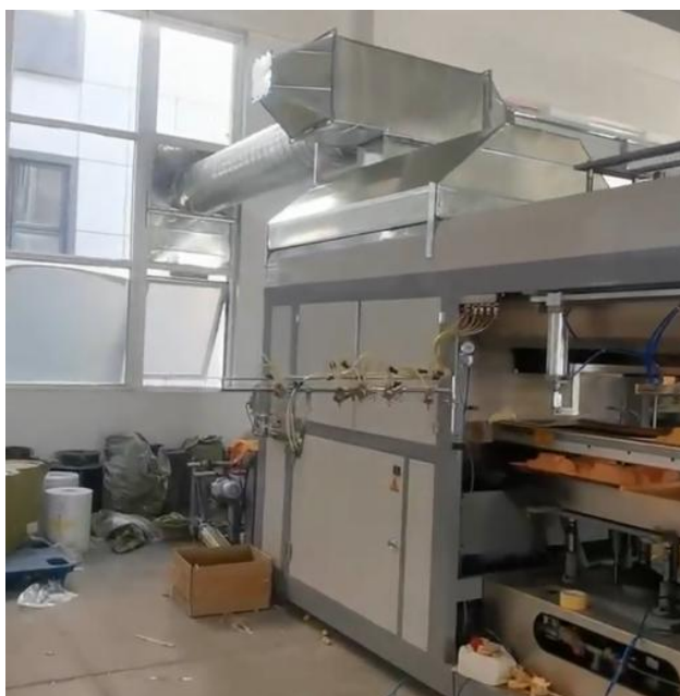
图 3 同类吸塑设备废气收集方式示意图
